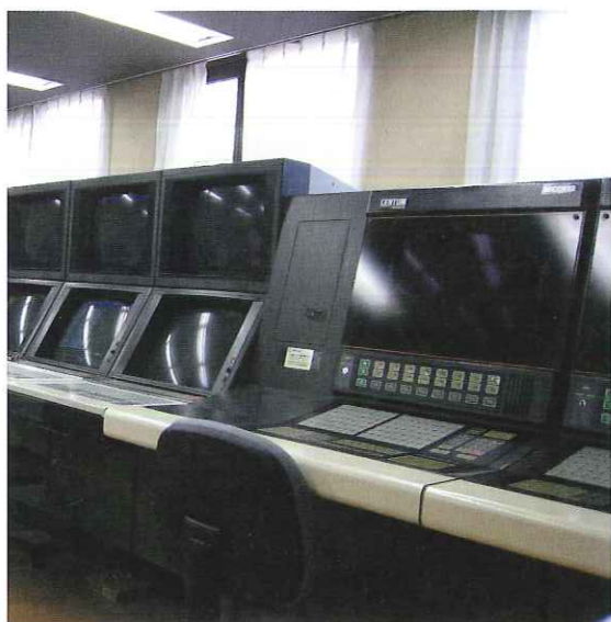
大型DCSシステム [分散型制御システム・社内設備(横河電機社製 CENTUMシステム)] ソウ・システム・サービスでは横河社、山武社、エマソン社のDCSを常備してお客先からのご要請に即日対応している
